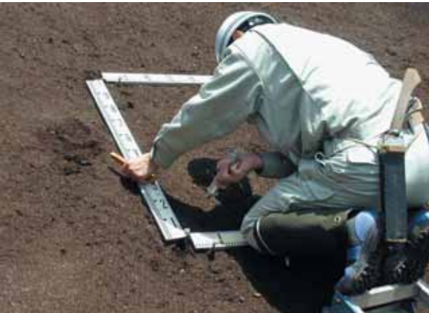
写真5 生育基盤材の硬度測定(山の神地区 2003.4.18)
