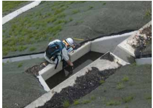
写真6 施工地流出水の酸性度測定(山の神地区 2003.6)
