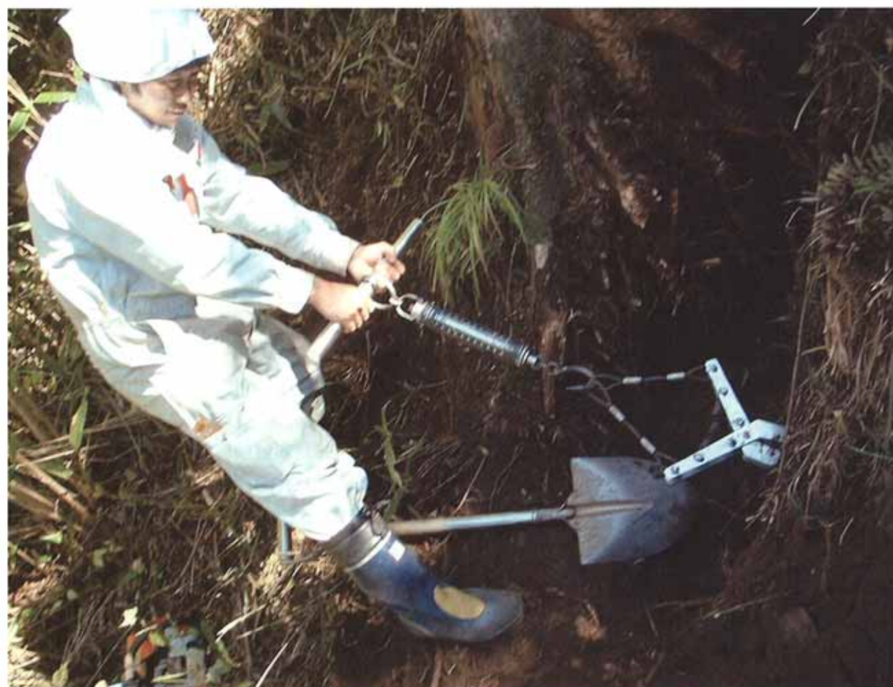
写真.1 根系引き抜き試験(信州大学農学部付属演習林内)
